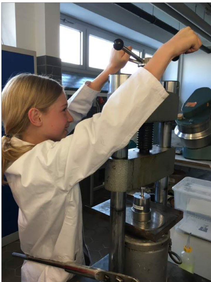
Abbildung 37.01 Kleine Fliesen mit einer Presse herstellen
