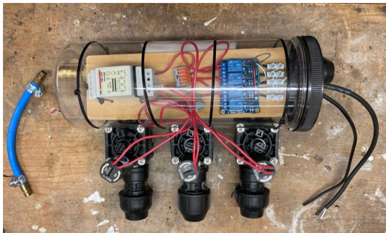
Abbildung 5 Verteilung - Relais mit Magnetventilen
